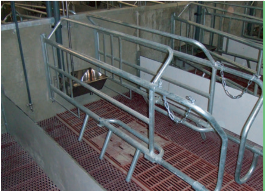
Geheel vrij dragend kraamhok met: Afwijzers, valbeugels en volledige lengte instelling.
